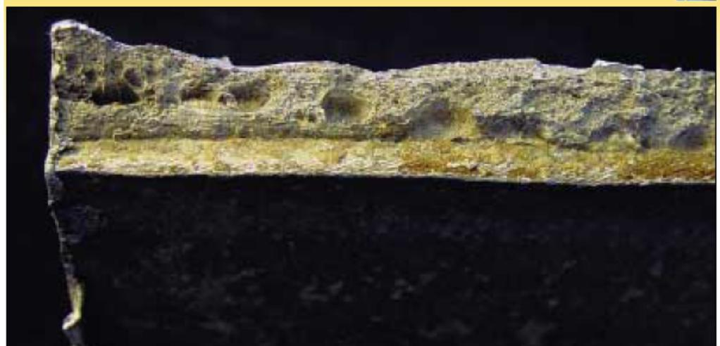
Fig. 2: Exemple d'une soudure poreuse
