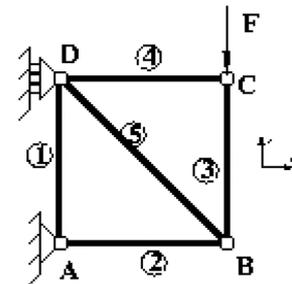
1. Ecrire l'équilibre des nœuds et en déduire les tensions dans chaque barre et les réactions aux appuis. Quelles sont les barres en traction et les barres en compression ?
