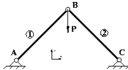
1. Peut-on calculer les réactions aux appuis en réalisant l'équilibre global du treillis ?
