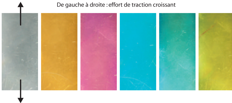
FIG. 6.2: Barreau soumis à une contrainte de traction croissante
