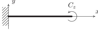
FIG. B.7 – Poutre rectiligne sollicitée en flexion pure.
