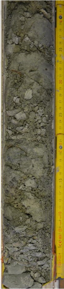
Figure 22 : brèche mécanique monogénique hétérométrique.
