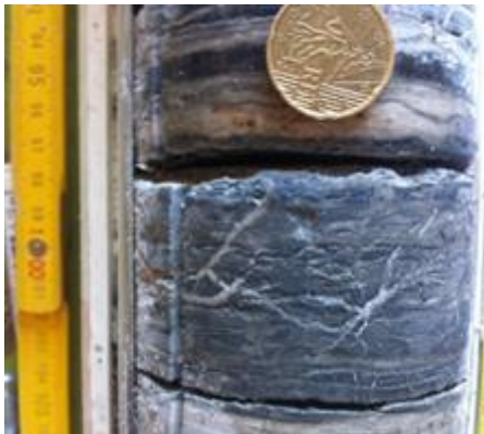
Figure 29 : Fentes diffuses à colmatage de gypse/anhydrite.
