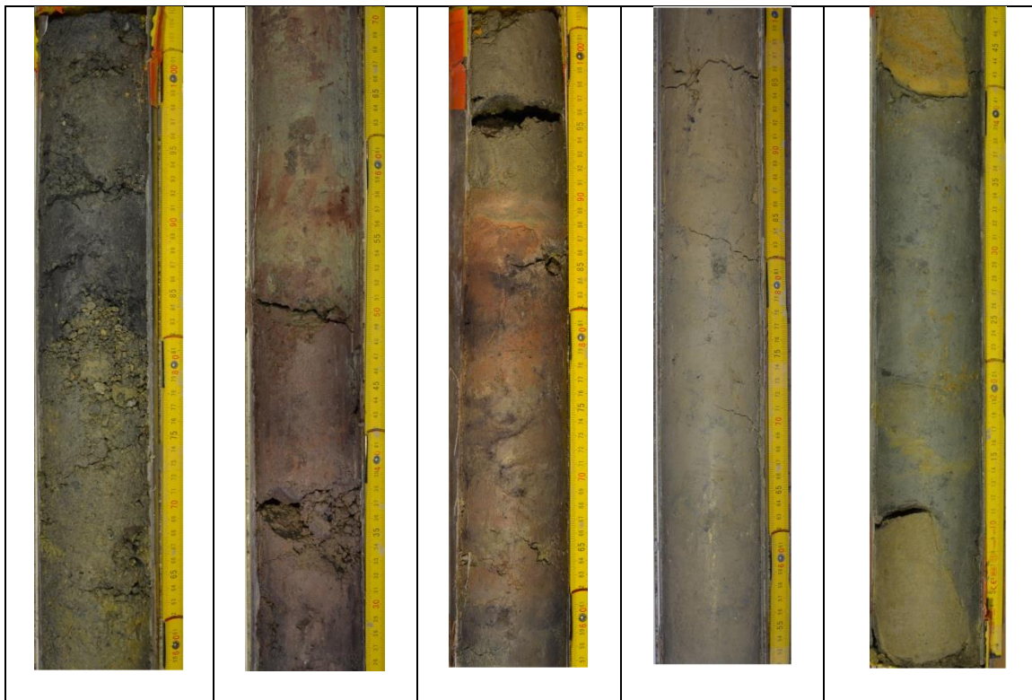
Figure 13 : Différentes couleurs des marnes rhétiennes dans le forage SC.1. Sur la dernière photo, nous observons des blocs effondrés de dolomudstone dans les marnes du Rhétien.
