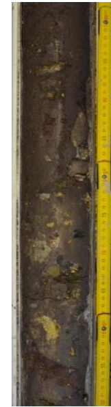
Figure 19 : Protocataclasite avec clastes de taille pluri millimétrique à pluricentimétrique de nombreuses origines.
