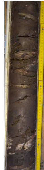
Figure 21 : Cataclasite avec clastes de taille décimétrique d'argilite verte/anhydrite.
