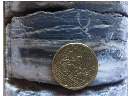
Figure 28 : Fente horizontale avec un colmatage de gypse fibreux et une géométrie en relais connectés.
