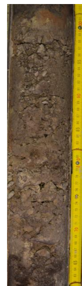
Figure 23: Brèche monogénique, hétérométrique avec clastes de dolomudstone et matrice marneuse.
