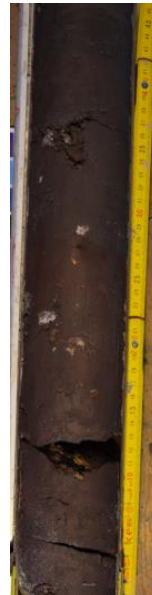
Figure 20 : Ultracataclasite avec des clastes de taille centimétrique d'évaporite.
