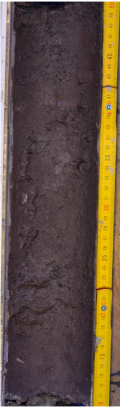
Figure 18: Roche de faille de type gouge.
