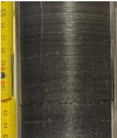
Figure 8: Argilite massive noire du Trias évaporitique.
