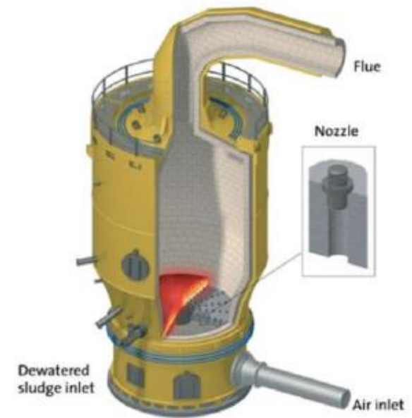
Figure 11 : Exemple de mono-incinérateur Pyrofluid™
