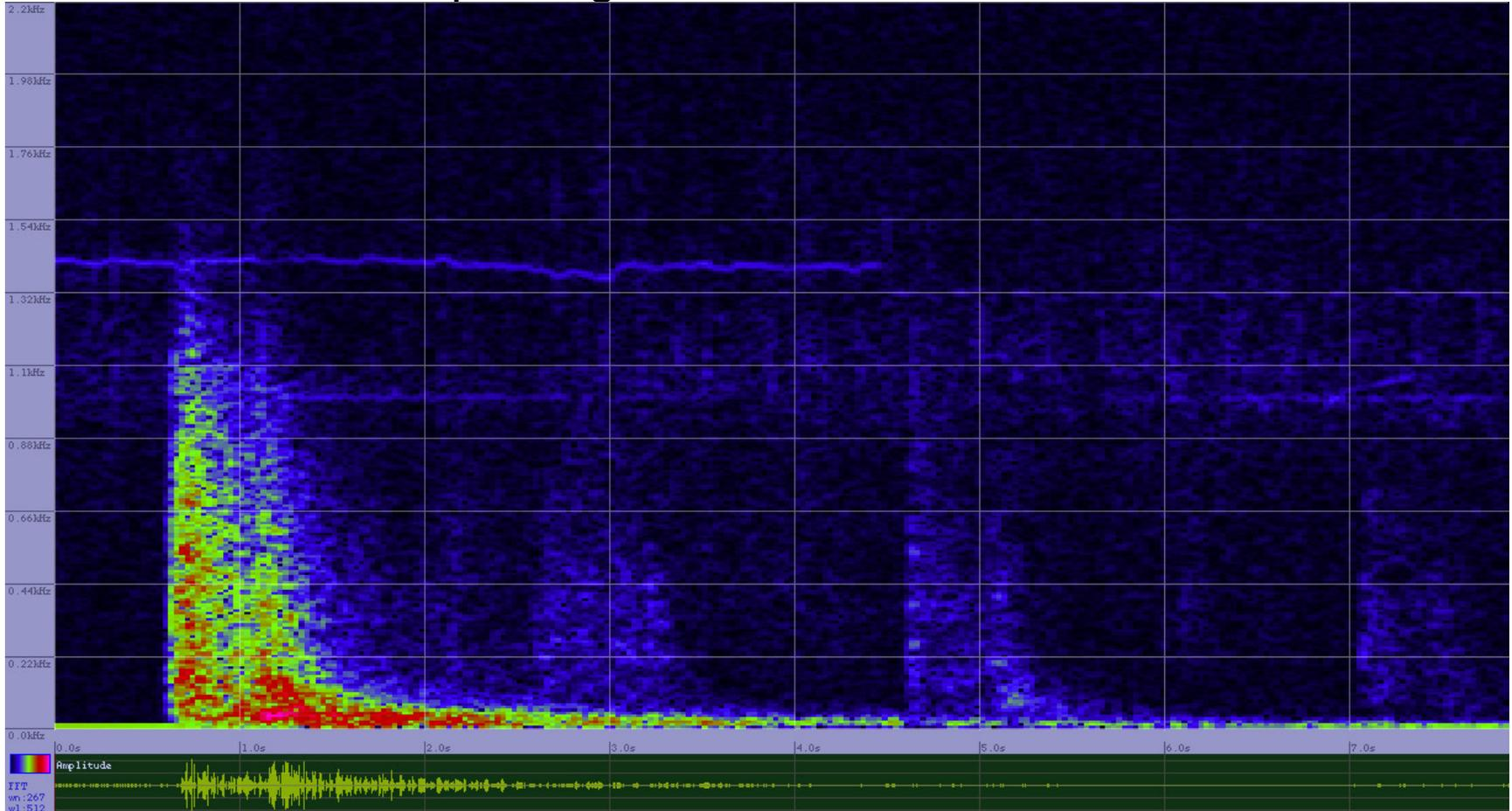
Le spectrogramme est une représentation à chaque instant  $t$  d'un signal, de son spectre de fréquence.
