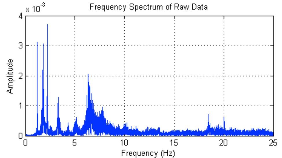
Ce signal est la réponse d'un bâtiment pendant un séisme
