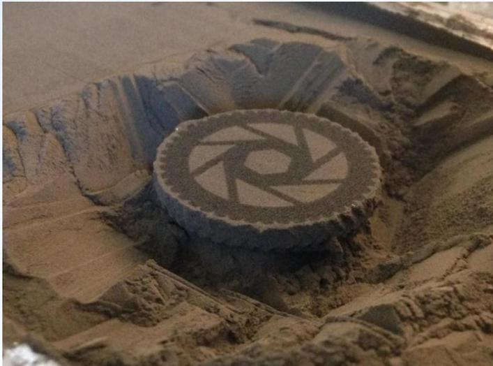
3. La plate-forme de construction se déplace vers le bas et la **lame racleuse recouvre la surface**, pour débiter une nouvelle couche.
