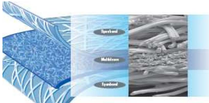
Les couches externes de Spunbond de l'emballage KIMGUARD\* fournissent une résistance et une durabilité exceptionnelles. Les multiples couches intérieures de Meltblown fournissent une barrière de protection optimale contre les bactéries et les liquides tout en permettant la pénétration des gaz stérilisants (vapeur, oxyde d'éthylène, formaldéhyde et plasma).
