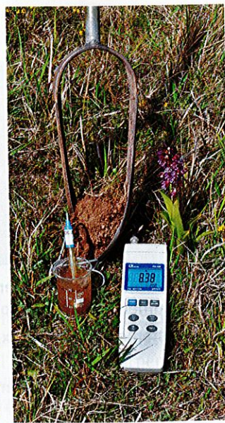
B Mesure de pH du sol du site A.
