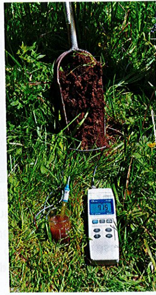
C Mesure de pH du sol du site B.
