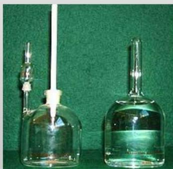
Détermination de la masse volumique du liquide par pesée sur une balance de précision à une température donnée;
