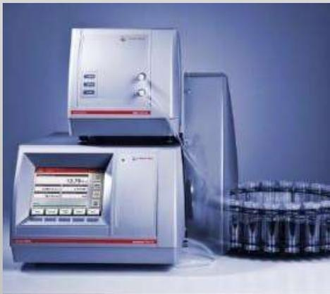
Le principe consiste à mesurer la période d'oscillation d'un tube contenant l'échantillon soumis à une excitation électromagnétique.
