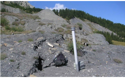
Piezomètre dans le glissement de Super-Sauze, Haute-Provence
