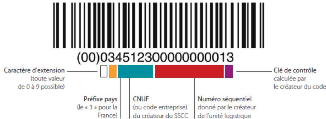
➤ Ce numéro unique sur 18 chiffres est l'un des éléments essentiels des applications de traçabilité. Il permet d'établir les liens entre le flux physique (unités d'expédition préparées, stockées, livrées, réceptionnées) et le flux d'information correspondant (avis d'expédition). Il permet aussi de retrouver dans les bases de données les informations de traçabilité dûment enregistrées relatives aux lots de fabrication
