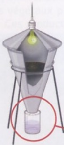
■ Récolte d'un échantillon de microfaune d'un sol à l'aide de l'appareil de Berlese puis observation à la loupe binoculaire.
