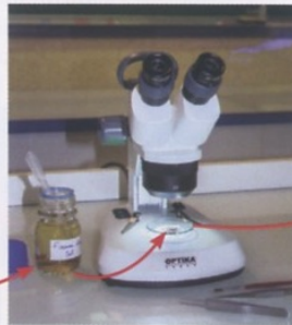
■ Récolte d'un échantillon de microfaune d'un sol à l'aide de l'appareil de Berlese puis observation à la loupe binoculaire.
