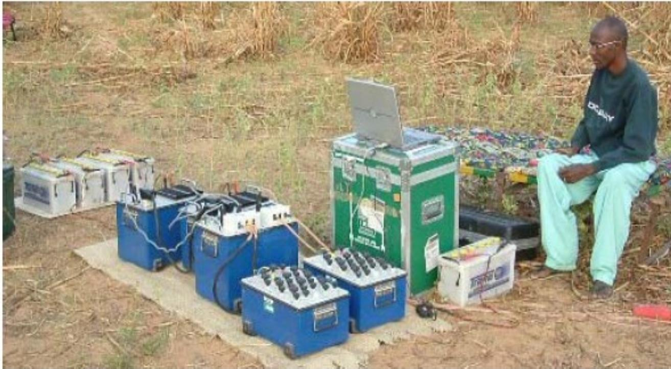
*Figure 1-29. Equipement de Résonance Magnétique Protonique NUMIS<sup>PLUS</sup> sur site
