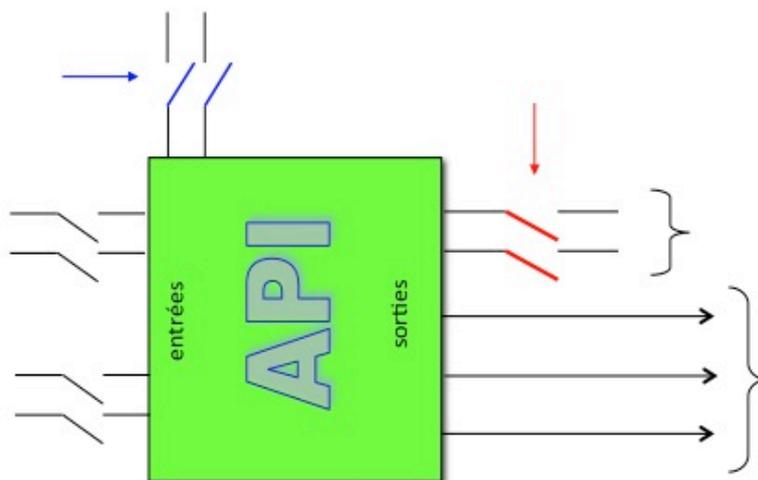
L'API peut ne pas être considéré comme élément de commande suffisamment sûr dans des domaines sensibles (Nucléaire, chimie, tunnels) pour garantir la mise en sécurité de la machine.
