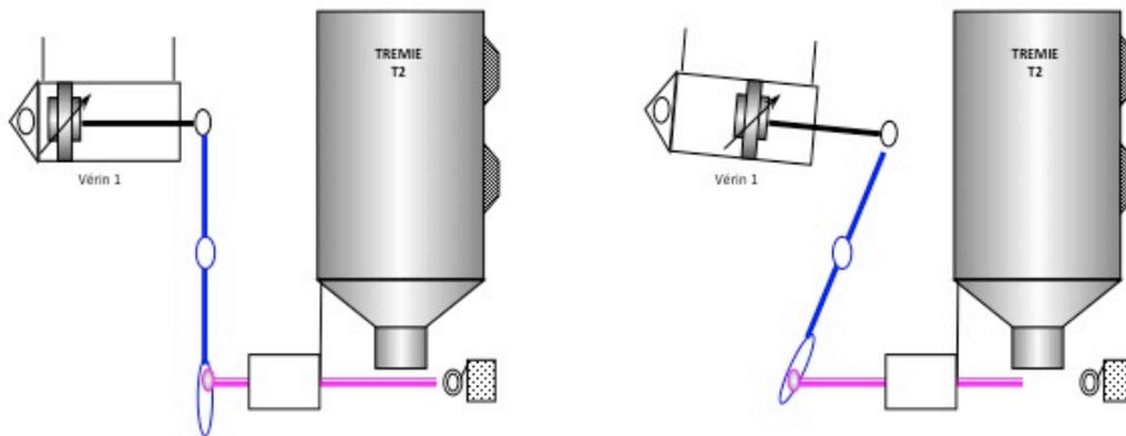
En cas de défaut (coupure d'air ou d'électricité, ARU,...), cette trappe doit se fermer.....
