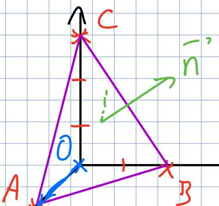
$$\vec{n} = \frac{\vec{AB} \wedge \vec{AC}}{\|\vec{AB} \wedge \vec{AC}\|} = \boxed{\frac{1}{\sqrt{7}} \begin{pmatrix} 6 \\ 3 \\ 2 \end{pmatrix} = \hat{n}}$$
