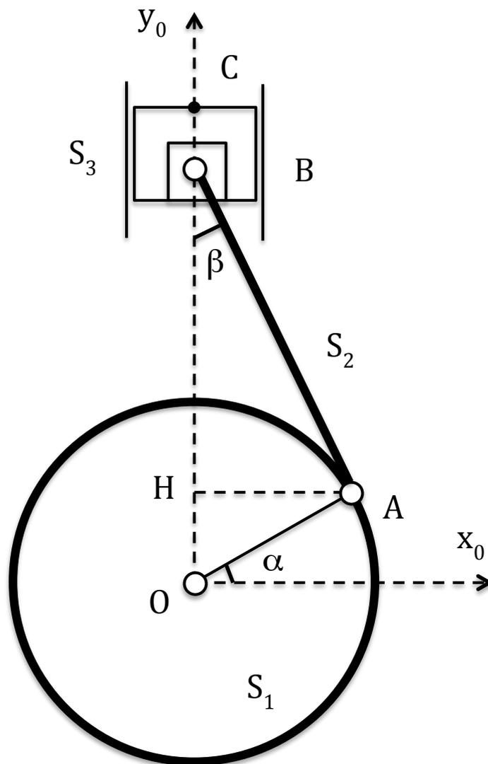
Figure 1 : Représentation du système bielle-manivelle-piston
