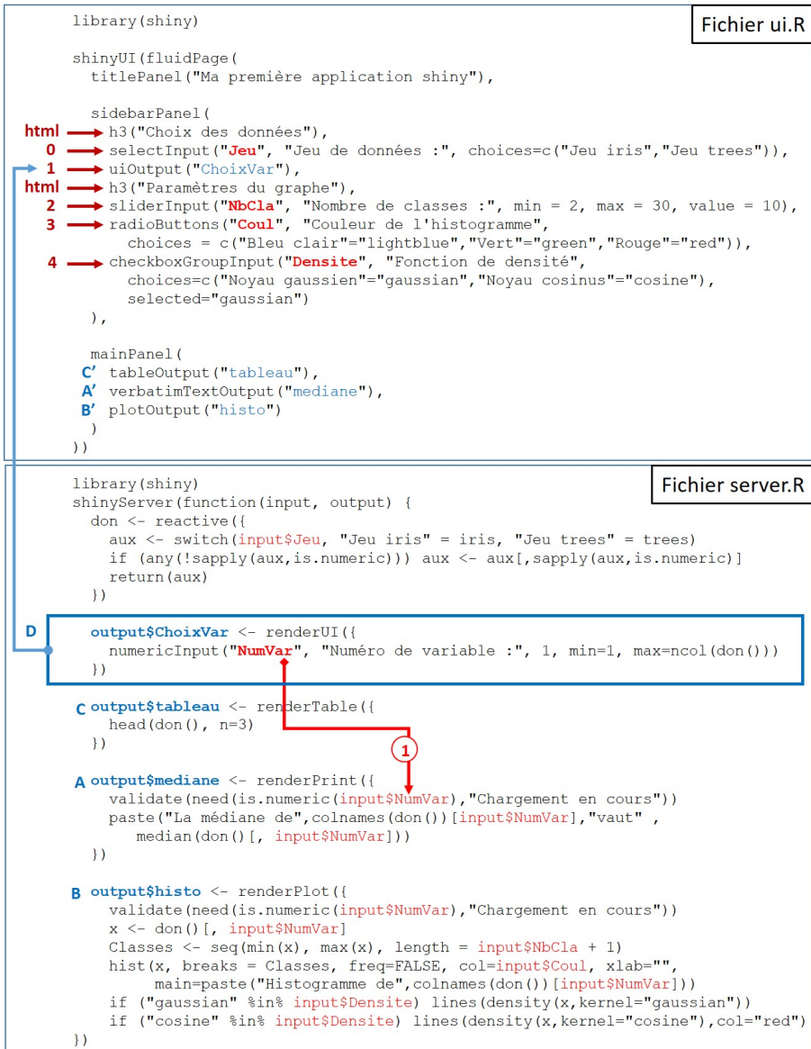
FIGURE 4.5 – Fichiers ui.R et server.R de l'application shiny. Les paramètres d'entrée sont en rouge, les sorties sont en bleu. La définition des paramètres d'entrée ou des résultats est en gras tandis que l'utilisation est en police normale.
