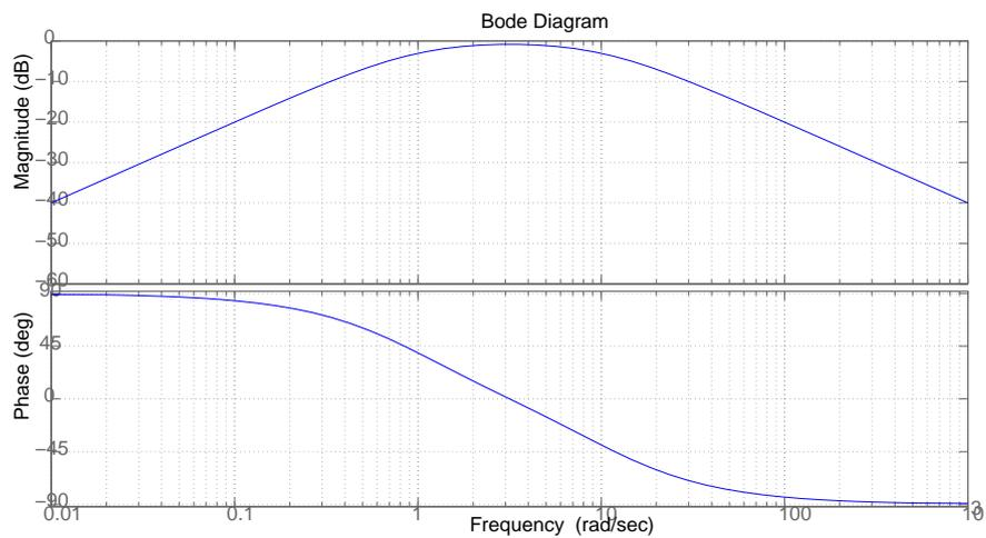
FIGURE 9 – Diagramme de bode d'un filtre passe bande obtenu en cascade un passe bas et un passe haut
