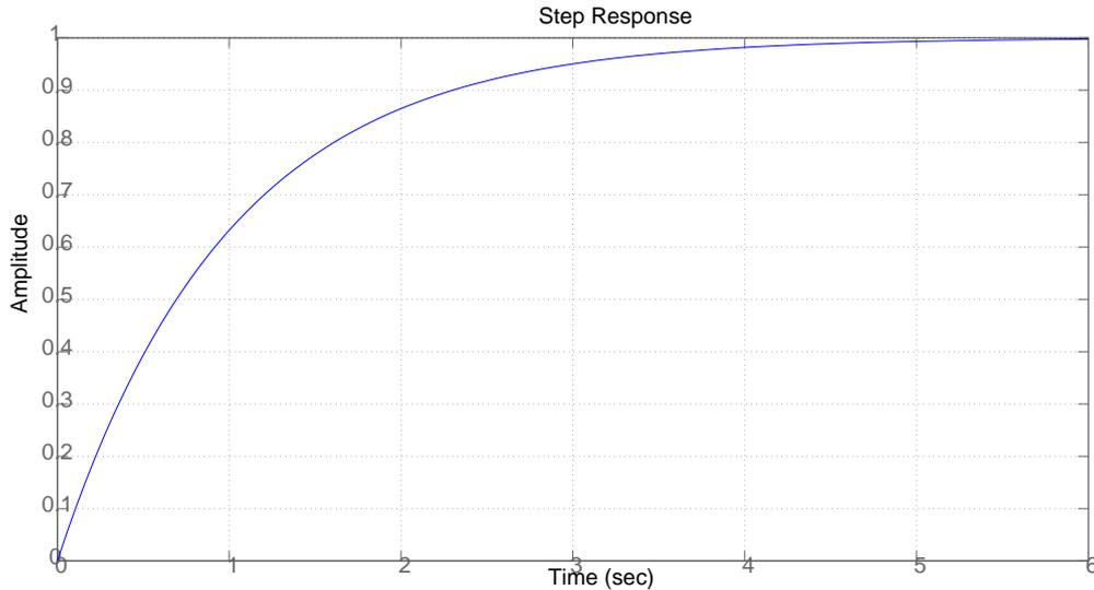
FIGURE 5 – Réponse à un échelon unitaire d'un filtre RC passif avec  $\tau = 1$
