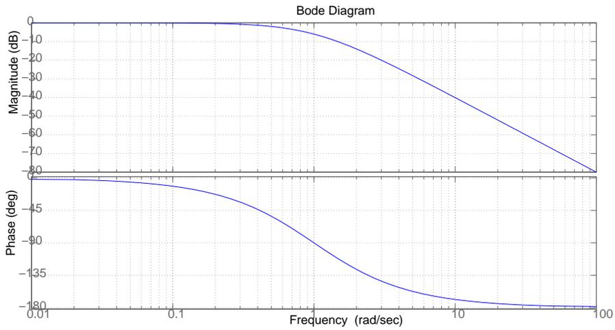
FIGURE 7 – Diagramme de bode d'un circuit RC passif avec  $\omega_0 = 1$  suivi en cascade du même filtre
