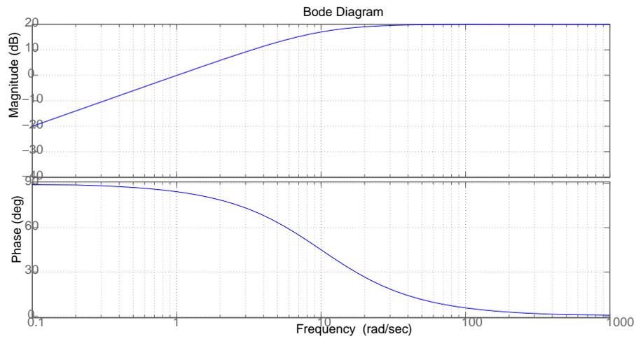
FIGURE 8 – Diagramme de bode d'un circuit CR passif avec  $\omega_0 = 10\text{rad}\cdot\text{s}^{-1}$
