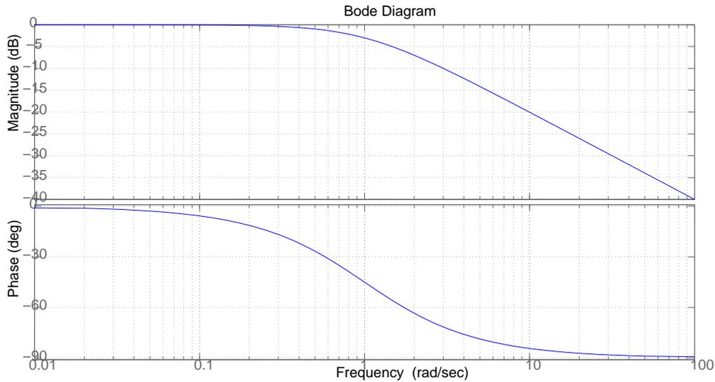
FIGURE 6 – Diagramme de bode d'un circuit RC passif avec  $\omega_0 = 1$
