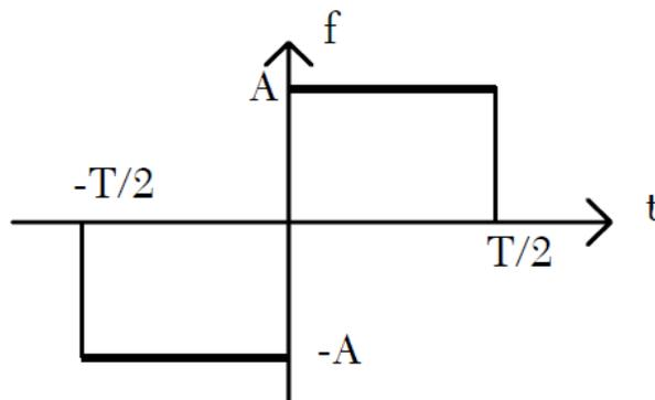
FIGURE 2 – Evolution de l'amplitude d'un signal carré symétrique
