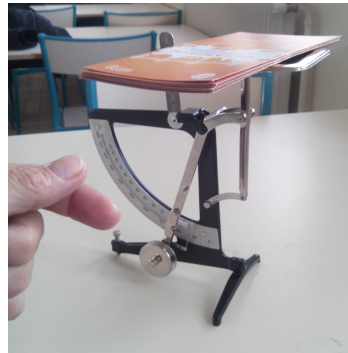
Figure 2 : Pesée de document grâce au pèse-lettre.
