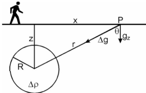
Calculer  $\Delta g_z$  le long du profil dans le cas de notre tunnel. On donne  $G=6.67E-11 \text{ N.m}^2.\text{kg}^{-2}$ ;  $\Delta\rho=-1200 \text{ kg.m}^3$ ;  $R=1,25 \text{ m}$ ;  $z=1,5 \text{ m}$ . Tracer le résultat en le
