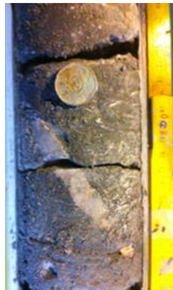
Figure 26 : Fente de tension d'ouverture pluri cm avec un colmatage d'anhydrite. La fente de tension n'est pas exactement verticale, probablement à cause d'une rotation due au glissement de terrain.
