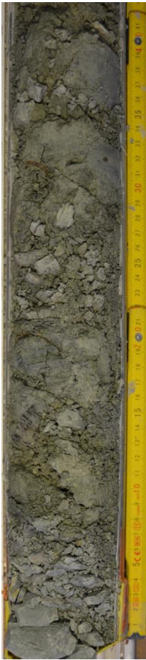
Figure 22 : brèche mécanique monogénique hétérométrique.
