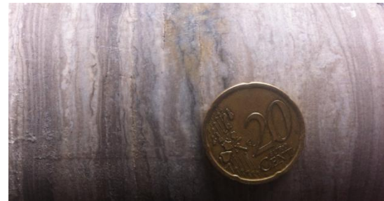
Figure 10: Banc d'anhydrite massif avec intercalation de fins bancs d'argile.
