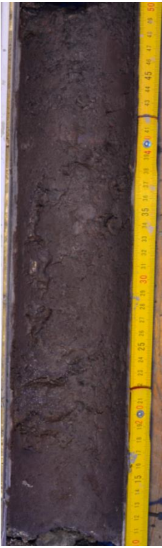
Figure 18: Roche de faille de type gouge.
