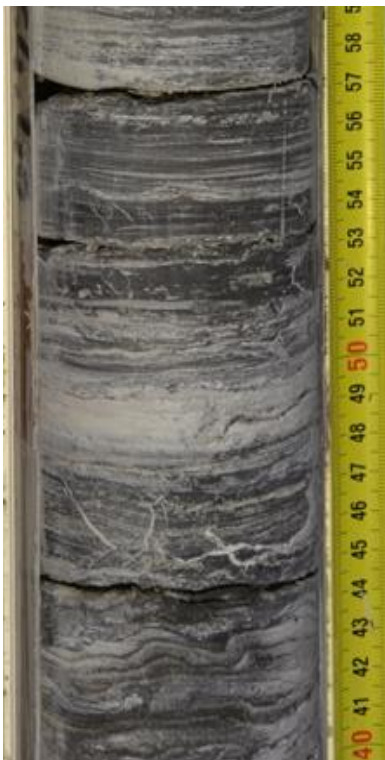
Figure 9 : Argilite avec bancs d'anhydrite de taille variable.
