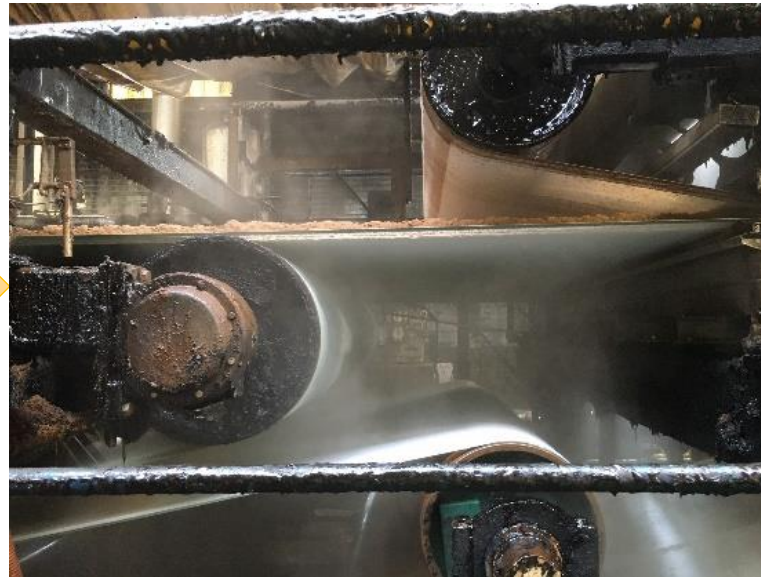
Pressage du matelas de fibre → 30% EMC
