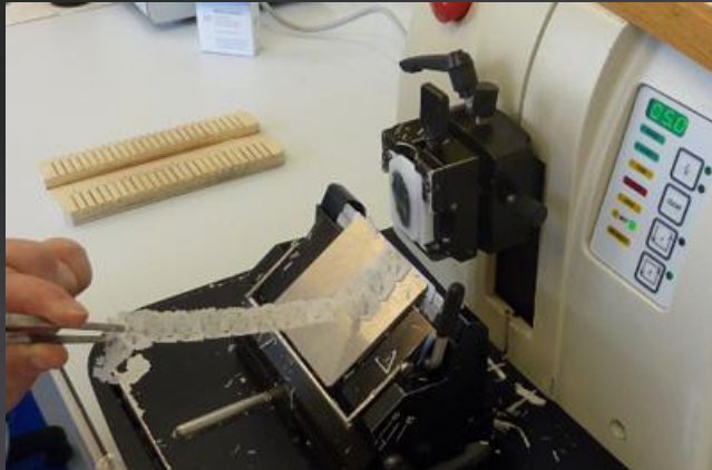
Le bloc de paraffine est placé sur le microtome et découpé en fine tranche
