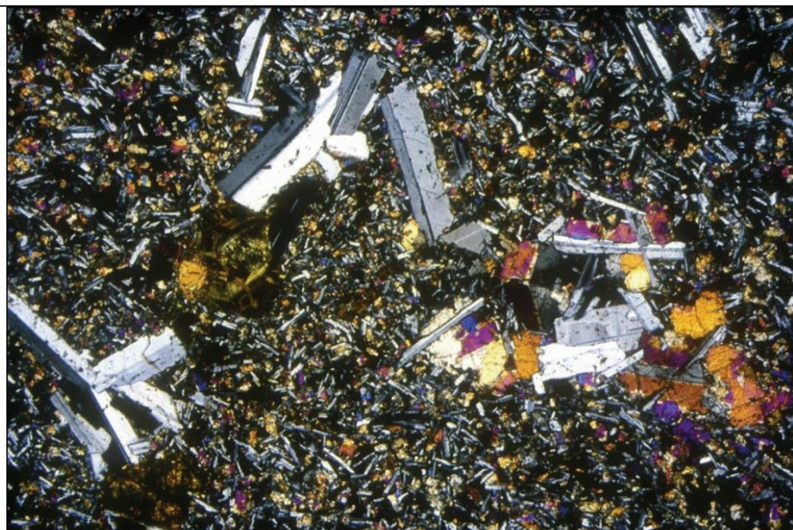
La pâte microlitique de ce basalte contient de nombreux minéraux opaques de magnétite
