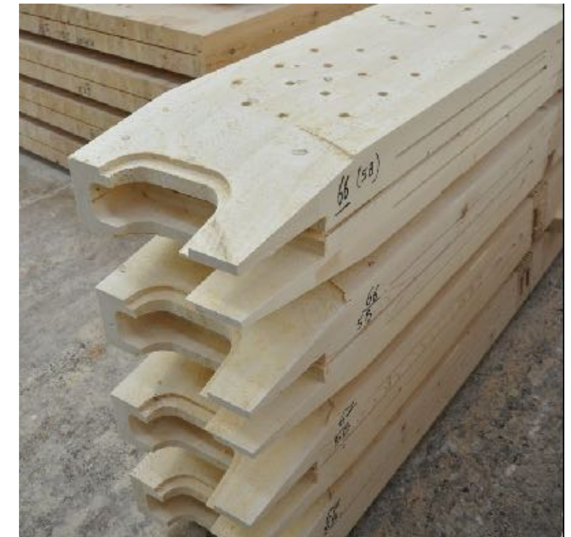
Barres taillées par CNC pour platines d'assemblages
