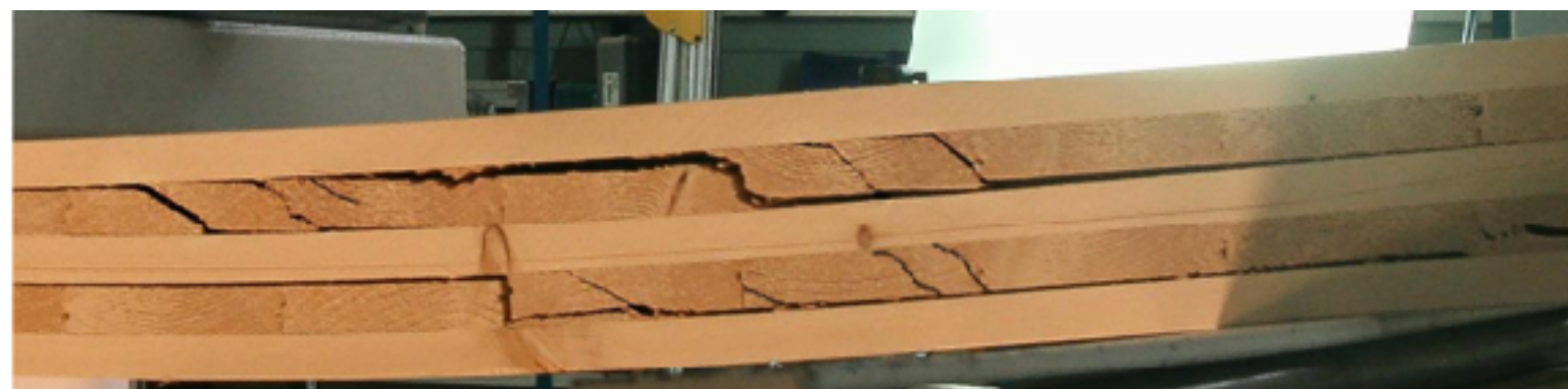
Rupture par cisaillement roulant
